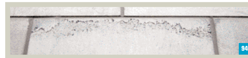
94 Zone stylolithique poreuse.
