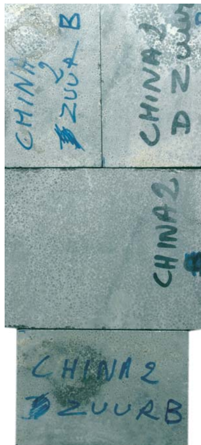
8 série 2 Deuxième du bas : l'échantillon de référence. Les autres échantillons ont été exposés à la solution B.
