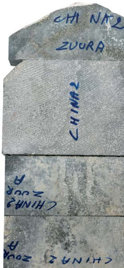
6 série 2 Deuxième du haut : l'échantillon de référence. Les autres échantillons ont été exposés à la solution A.
